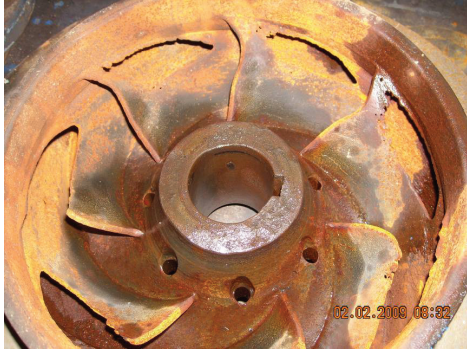
Resim 2- Kavitasyon sonucu hasara uğramış çark
