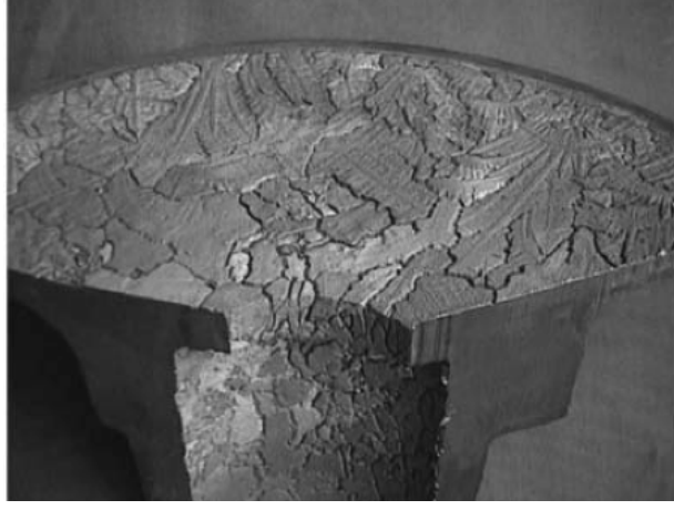
Şekil 5. Bir pompa gövdesinin salmastra bölgesinde oluşan tanecikler arası korozyon
