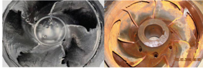
Şekil 4. Kaviteasyonla aşınan östenitik-ferritik paslanmaz (sol) ve pik döküm(sağ) çark
