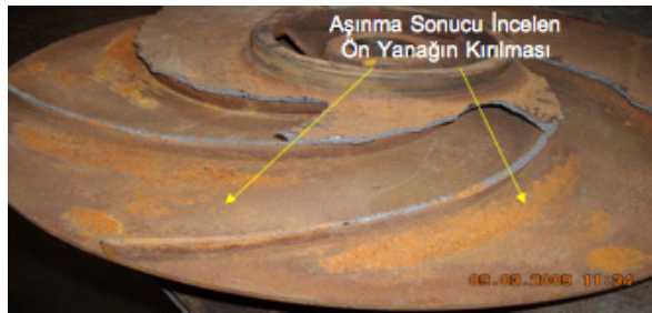
Şekil 2. Aşınma ve Rulman problem sonucu parçalanmış bir çark
